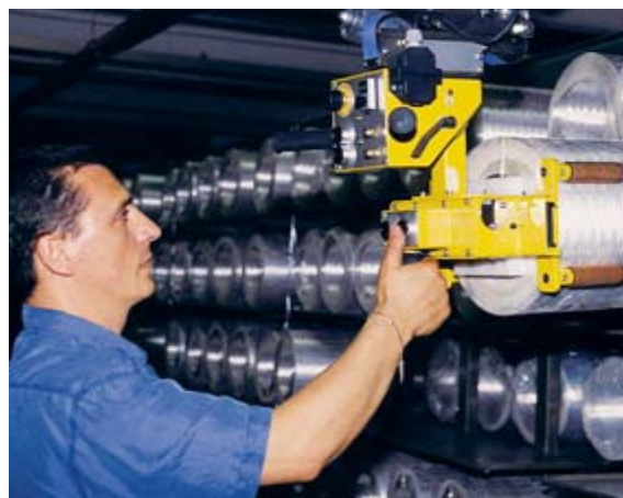
L'azienda ha imposto il motto «STOP – Pensa, poi solleva»: oggi lo stesso lavoro viene effettuato con un apparecchio di sollevamento («balancer» di pesi). Grazie alla meccanizzazione, il lavoro è diventato molto più sicuro, meno rischioso per la salute e la produttività è aumentata.
