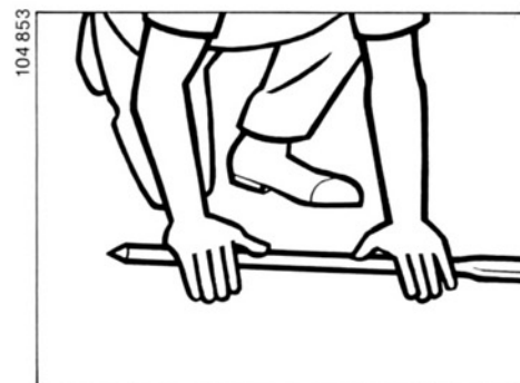
Bild 84 richtig Um Knöchelverletzungen zu vermeiden, ist die für das Heben von Lasten verwendete Hebestange mit flacher Hand zu stoßen.
